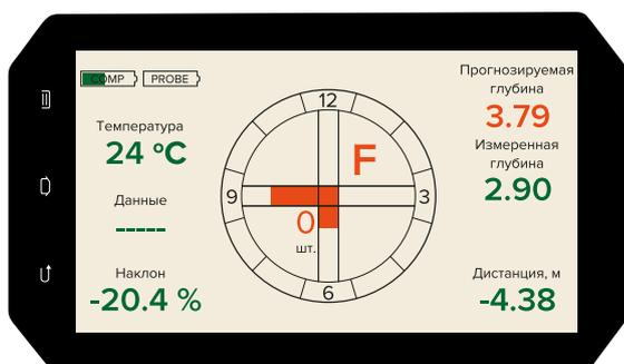
Sämtliche Daten vom Empfänger werden an das Fernanzeigegerät übertragen und werden ständig darauf angezeigt, einschließlich der Anweisungen zum nächsten Ortungspunkt
